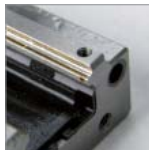
上儲油塊完好 供油正常 軌道面正常
