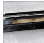
潤滑油乾涸殘留物 下儲油塊破損
