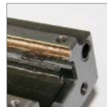
潤滑油乾涸殘留物 上儲油塊破損
