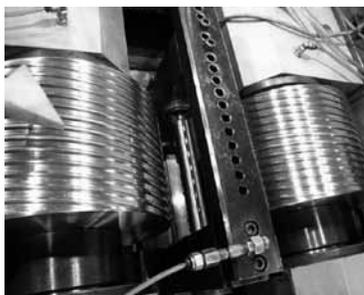
本公司采用最先进德国数值电控滚牙机，转造制程中，牙轮两轴油压缸皆采用伺服油压校正油压压力及定位精度。
